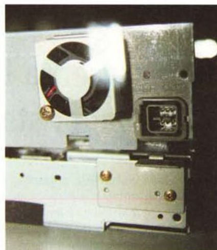
Una curiosità: sebbene Clarion ed Intel abbiano fortemente voluto l'USB nella trasmissione dei dati lungo tutta l'auto, non hanno ritenuto i connettori "standard" all'altezza del gravoso impiego automobilistico, prontamente sostituendoli con un più "cattivo" connettore proprietario.
